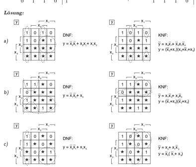
Aufgabe 3c ist ein Beispiel dafür, daß die DNF und die KNF getrennt voneinander minimiert werden sollen: Ein und derselbe '\*' – beispielsweise der '\*' im Feld 1111 – kann bei der Bestimmung der DNF als 1 und bei der Bestimmung der KNF als 0 behandelt werden.
